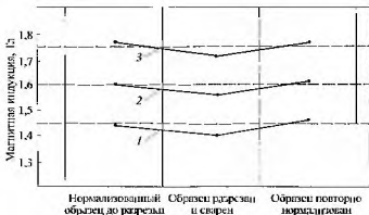
Рис. 126. Влияние сварки образцов на величину магнитной индукции при напряженности магнитного поля, А/м
